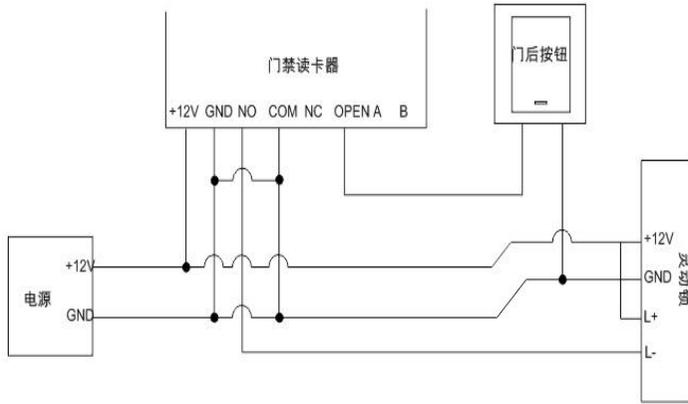
磁力锁接线图示例:
